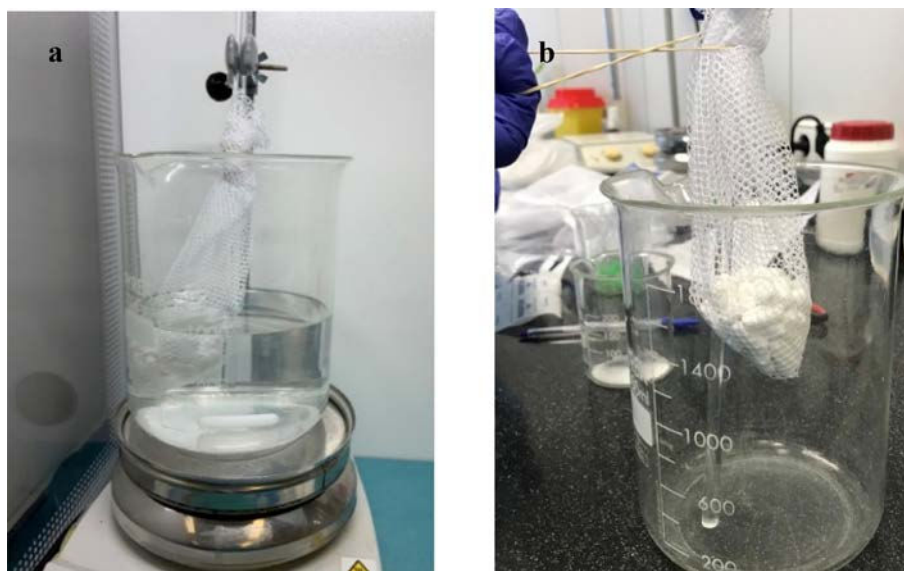
Figura 1. Ensayo con modelo in vitro . a) Comprimidos de divalproato sódico dentro de LGS. b) Comprimidos de divalproato sódico fuera de LGS.
